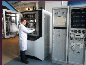
Практика на промышленном оборудовании, разработанном в НОЦ «Ионно-плазменные технологии» (установка напыления оптических покрытий)
