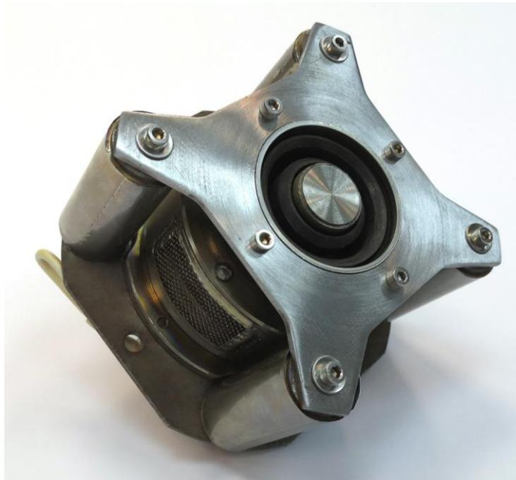
Двигатель с анодным слоем – разновидность двигателей с замкнутым дрейфом электронов – обеспечивает создание тяги за счет ускорения ионов рабочего вещества в скрещенных магнитном и электрическом поле.
